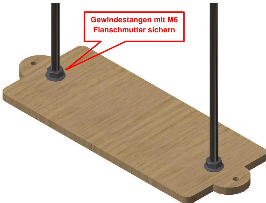
3.) Flanschmuttern auf Gewindestangen vormontieren:
