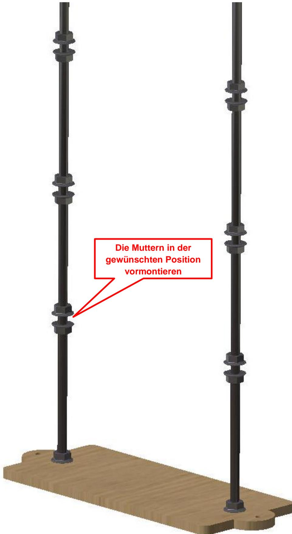
4.) Verbindungsplatten anbringen und mit Flanschmuttern fixieren:
